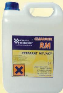
Моющие средство для удаления сильных загрязнений. Микроэмульсионное щелочное моющее и обезжирающее средство с pH 9-9,5. Эффективно удаляет эксплуатационные смазки, минеральные масла, смолу, асфальт и т.п. Разбавляется водой до соотношения 1:50. Макс. темп. работы для концентрата 73°C, для раствора водой 1:5 темп. 48°C.
