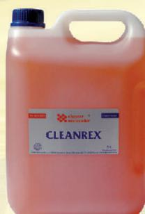
Моющие средство с pH 7-8. Удаляет смазки, минеральные масла, растительные и животные жиры. Не оказывает отрицательного воздействия на большинство красок, лаков, пластмасс, алюминия и меди. Для применения в холодном и подогретом виде (до 80°C). Разбавляется водой до соотношения 1:20. Рекомендуется так же для мытья вручную.
