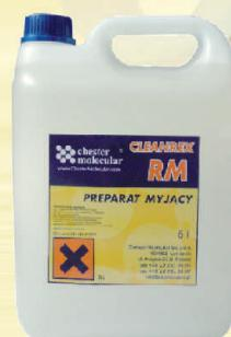
Моющие средство для удаления сильных загрязнений. Микроэмульсионное щелочное моющее и обезжирающее средство pH 9-9,5. Эффективно удаляет эксплуатационные смазки, минеральные масла, смолу, асфальт и т.п. Разбавляется водой до соотношения 1:50. Макс. темп. работы для концентрата 73°C, для раствора водой 1:5 темп. 48°C. Рекомендуется так же для мытья вручную и методом погружения.
