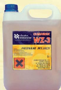
Сильно щелочное моющие средство pH 14. Удаляет эксплуатационные смазки, минеральные масла, растительные и животные жиры, белки. Не применять на алюминиевых поверхностях. Для применения в холодном и подогретом виде (до 70°C). Разбавляется водой от 1:1 до 1:40. Рекомендуется так же для мытья вручную.
