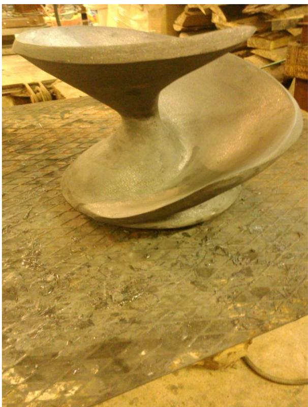
5) Нанесение защитных покрытий **Металлополимер «SHEG® - Metal Liquid (Керамика)»**,
