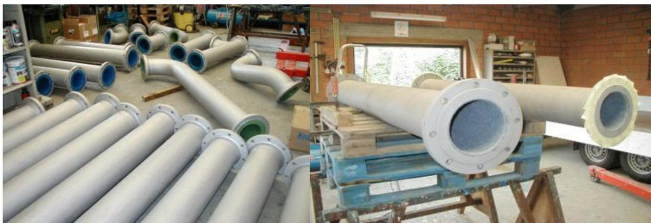
Двухметровые трубы диаметром 200 мм были обработаны растворителем, после чего был нанесен материал **Металлполимер «SHEG® – Metal Liquid (Керамика)»** и **Эмаль «SHEG®-774PU»**.
