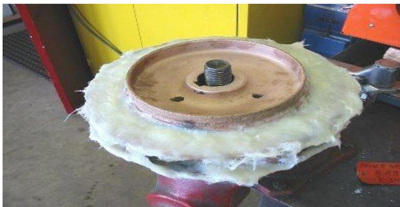
Рабочее колесо было восстановлено с использованием основного ремонтного **Металлополимера «SHEG® - Metal Paste (Смесь минералов)»**. Это сформировало геометрию колеса.
