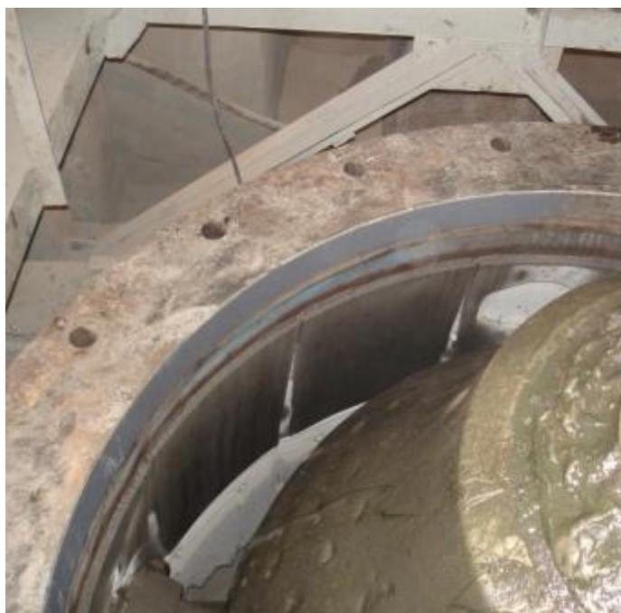
2. Двухкомпонентный полимерный материал **Металлополимер «SHEG® Metal Paste(Сталь)»** был нанесен на поверхность в течении 2-х часов. После этого дробилка была собрана и через 8 часов (после набора твердости материала) введена в эксплуатацию. В течение этого времени персонал выполнял другие ремонтные работы на этом агрегате.
