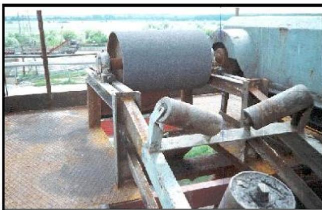
Ролик транспортера смонтирован.
