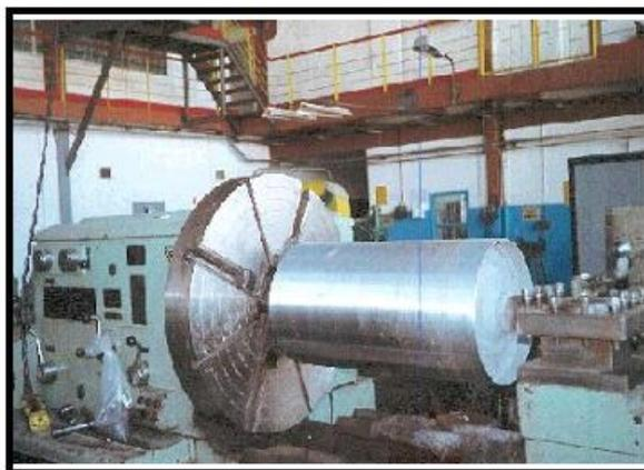
На этом рисунке показан ролик после зачистки поверхности.
