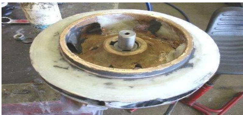
Далее рабочее колесо подвергается механической обработке и приведено к прежней геометрии (к исходному размеру и профилю).
