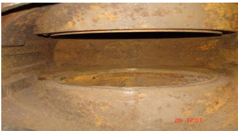
Был произведен ремонт дефектов уплотнительных колец материалом **Металлополимер «SHEG® – Metal Paste(Сталь)»**. Материал был нанесен в канавки и кратеры, после чего был шлифован до нормальных размеров поверхности колец.
