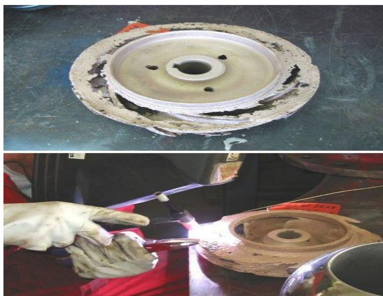
Сначала необходимо восстановить внешний контур рабочего колеса (диаметр). Для этого используют медный провод и производят сварку каркаса, чтобы нанести основной ремонтный **Металлополимер «SHEG® -Metal Paste (Смесь минералов)»** с использованием стеклоровинга.
