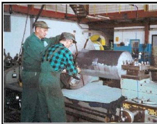
Нанесение жидкого керамического покрытия.
