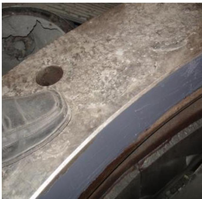
3. Применение полимерного материала **Металлополимер «SHEG® -Metal Paste(Сталь)»** позволило восстановить изношенную поверхность и уплотнить посадочное место в кратчайшие сроки, что способствовало быстрому восстановлению производственной деятельности и дальнейшей стабильной эксплуатации конусной дробилки в течении нормального межремонтного периода (2 месяца).
