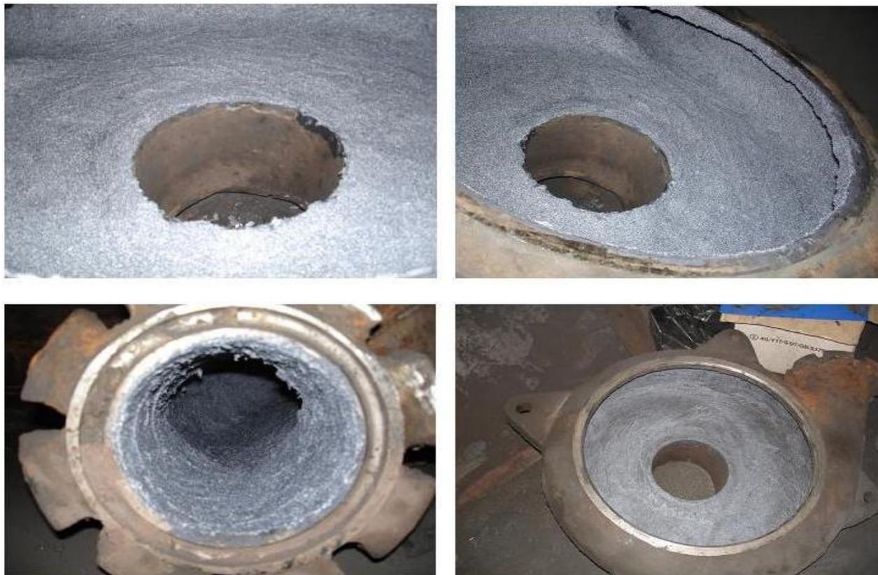
Все работы были выполнены в течение 1 смены. Процесс полимеризации полимерных материалов при нормальной температуре +20<sup>0</sup> С - 24 часа (при необходимости процесс полимеризации может быть ускорен путем нагрева до нескольких часов). После окончания процесса полимеризации, улита готова к вводу в эксплуатацию, а её ресурс увеличен по сравнению с новой.
