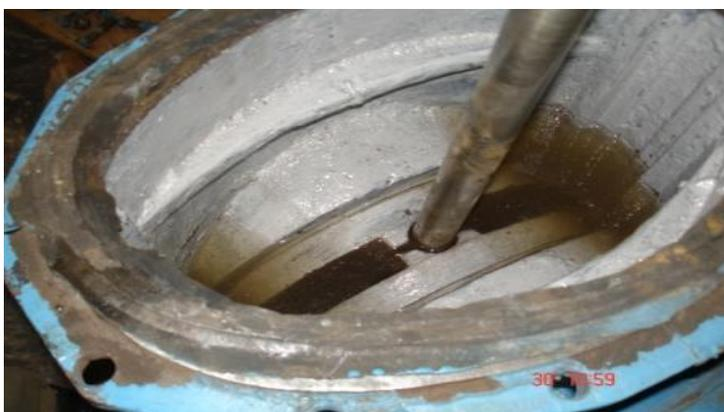
Корпус был очищен пескоструйным аппаратом и покрыт материалом Эмаль «SHEG®-774PU» с целью предотвращения коррозии, снижения гидравлического сопротивления и увеличения срока службы задвижки.
