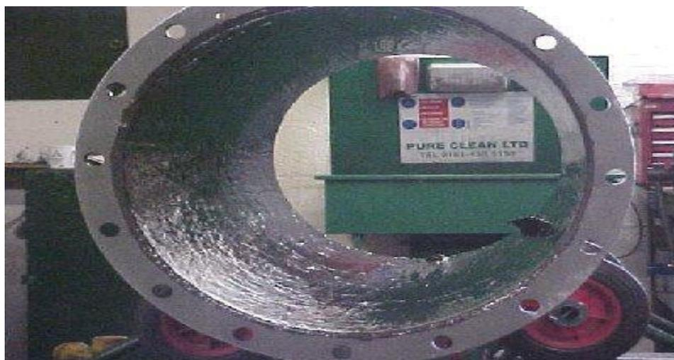
Далее корпус был покрыт стойким к абразиву материалом **Эмаль «SHEG®-774PU»** .
