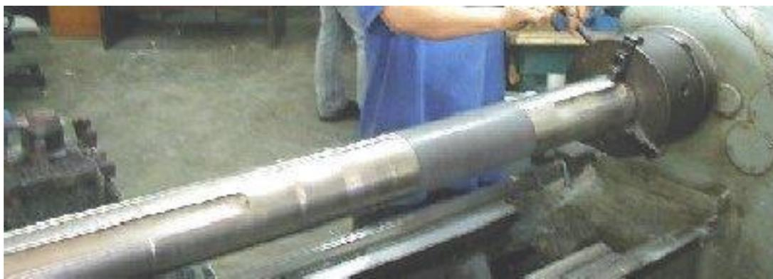
После нанесения и первичного набора твердости материала, лишний материал был убран на токарном станке до заданных размеров вала.
