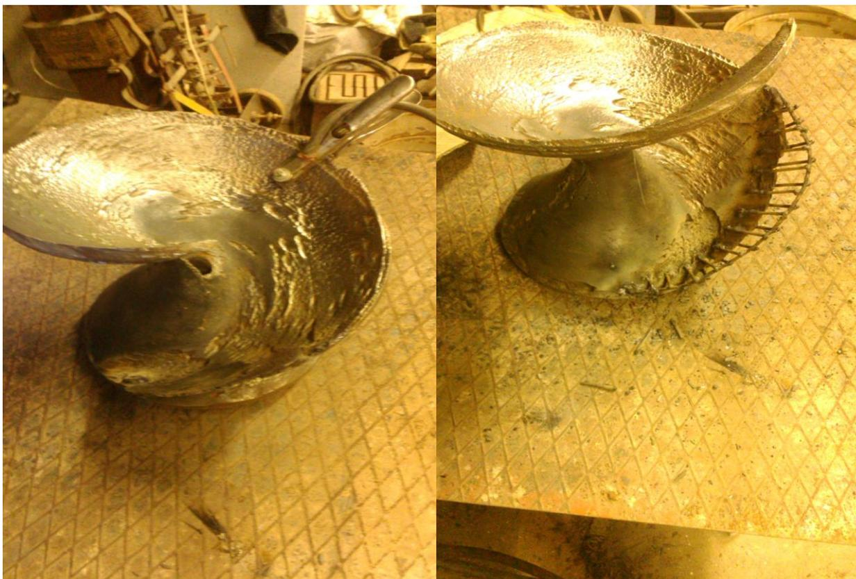
3) Грунтование Грунт «SHEG®-560EP» и восстановление геометрии колеса
