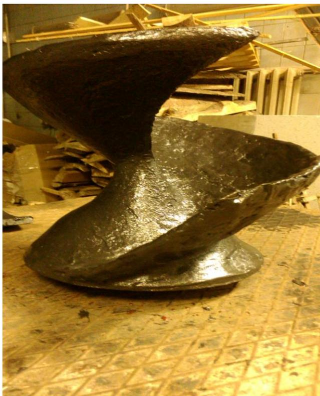
4) Механическая обработка колеса до нужных геометрических размеров
