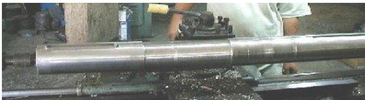
Вал находится в токарном станке, на котором сильно изношенная область была сточена на 6 мм, чтобы позволить материалу **Металлополимер «SHEG® – Metal Paste(Нержавеющая сталь)»** быть качественно нанесенному на необходимую область. Края участка с обеих сторон, где наносится материал, выполнены под 45%-ым углом. (Это важная часть технологии восстановления)
