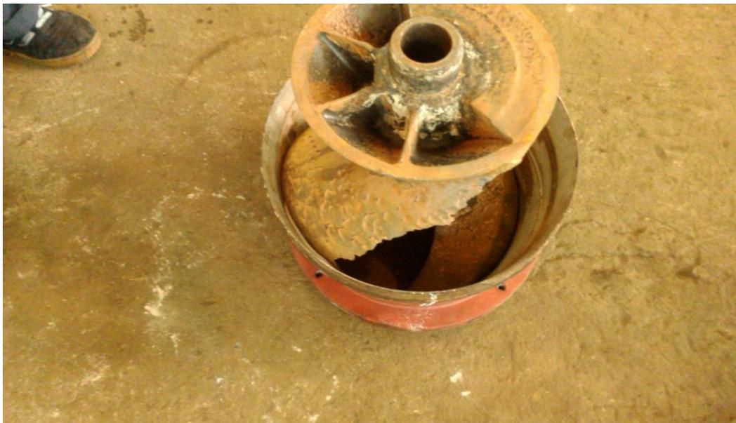
2) Пескоструйная обработка колеса и создание скелета лопасти
