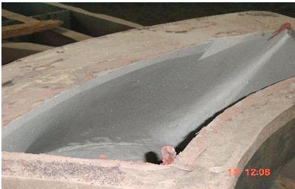
Металлополимер может быть использован для любых других элементов оборудования. После выполнения ремонта с целью повышения стойкости оборудования были нанесены два слоя материала **Металлополимера «SHEG® – Metal Liquid(Сталь)»** и **Эмаль полиуретановая «SHEG® -774PU»** для стойкости к абразиву.
