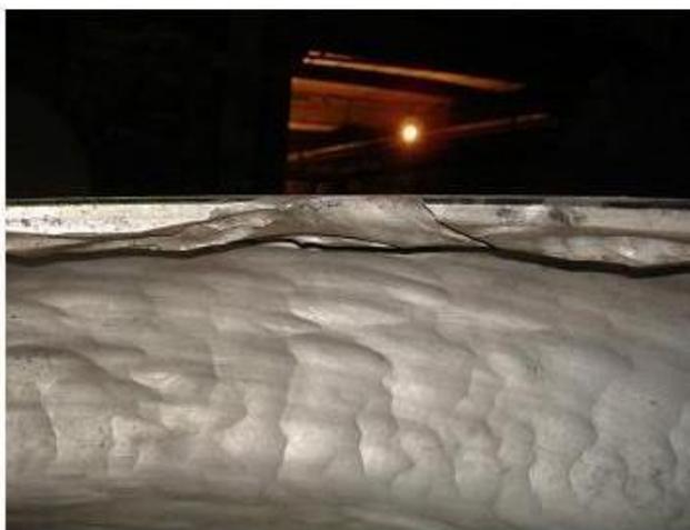
2. Произведен ремонт кратеров, отверстий и восстановление геометрии поверхностей сопряжения корпуса с другими элементами насоса (вал, защитный диск). Удобно и эффективно использовать двухкомпонентную полимерную систему: **Грунт «SHEG®-560EP» + Металлополимер «SHEG® – Metal Paste (Сталь)»**, которая имеет высокий предел прочности, превосходные адгезионные свойства, стойкость к абразиву.
