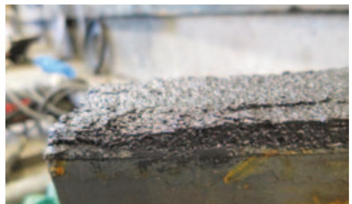
Металлополимеры WEICON – это двухкомпонентные составы из эпоксидных смол с различными наполнителями (алюминий, титан, бронза, сталь, минералы (карборунд, циркон) и т.д.), которые после смешивания полимеризуются практически без изменения в объёме. Застывший материал может подвергаться механической обработке. Металлополимеры WEICON – идеальный материал для проведения быстрых, долгосрочных и экономичных ремонтов, технического обслуживания.
