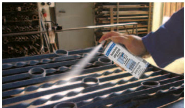
Обеспечивают долговечную, антикоррозионную и декоративную защиту металлических поверхностей. Смесь природных и синтетических смол с пигментами: цинка, алюминия, меди, нержавеющей стали, латуни и т.д.
